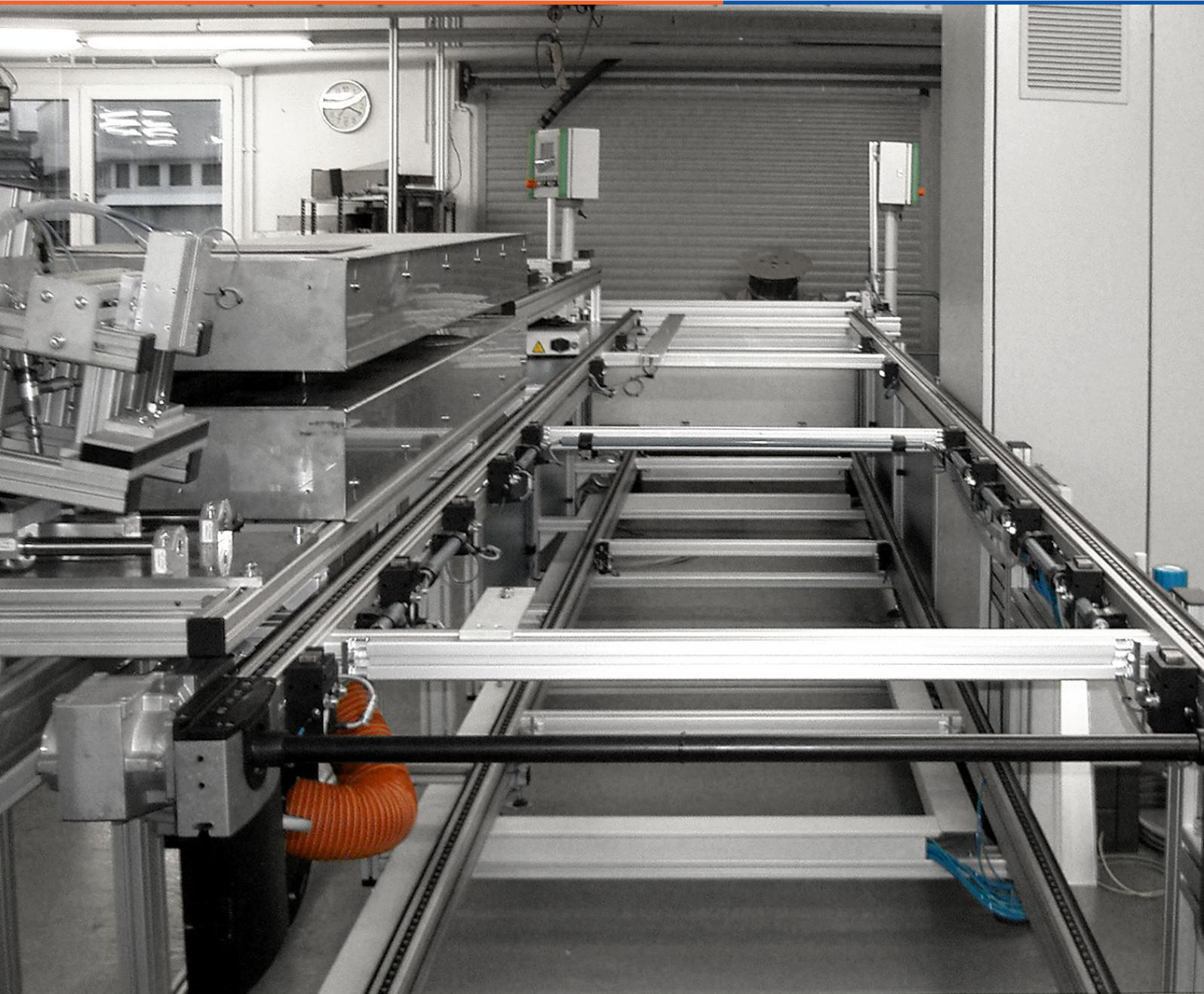
Ganz links am Bildrand ist die Verpresseinheit zu sehen, dahinter der Schrumpftunnel. Auf der rechten Seite ist der Schaltschrank platziert, ganz hinten im Bild sind die Bedienelemente angeordnet.
